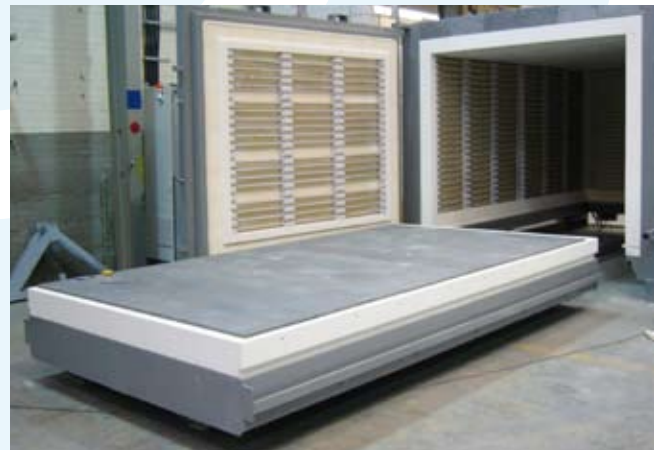
Elektrisch beheizter Herdwagenofen HWE 15,8 m³ zum Tempern von Quarzquadern, konzipiert auf Kundenwunsch. Besonderheit: elektrisch verfahrbarer Herdwagen für 10t Charge. Anschlussleistung 450 kW, Tmax 1300°C
