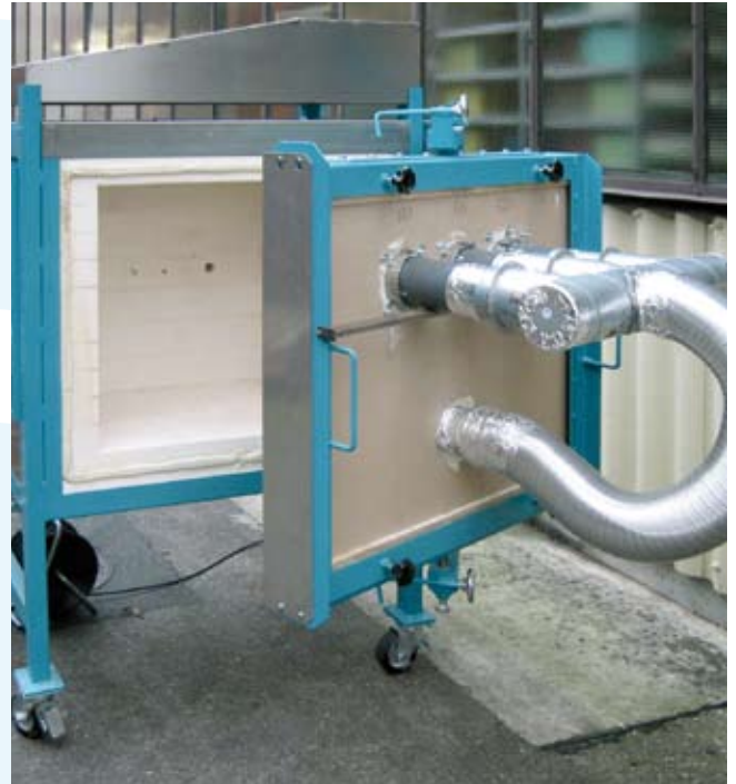
Gasbefeuertes Kammerofen KG 450 A in Sonderausführung, zum Test von Feuerschutzmanschetten. Besonderheit: schnelle Aufheizrate zur Brandsimulation und Datenarchivierung. Anschlussleistung 60 kW, Tmax 1200°C.
