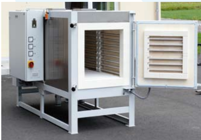
Elektrisch beheizter Kammerofen KE 950 S in Sonderausführung zum Wärmebehandeln von langen Blechteilen. Mit forcierter Kühlung durch geregeltes Gebläse und 2 geregelten Heizzonen. Anschlussleistung 54 kW/80A, Tmax 1100°C
