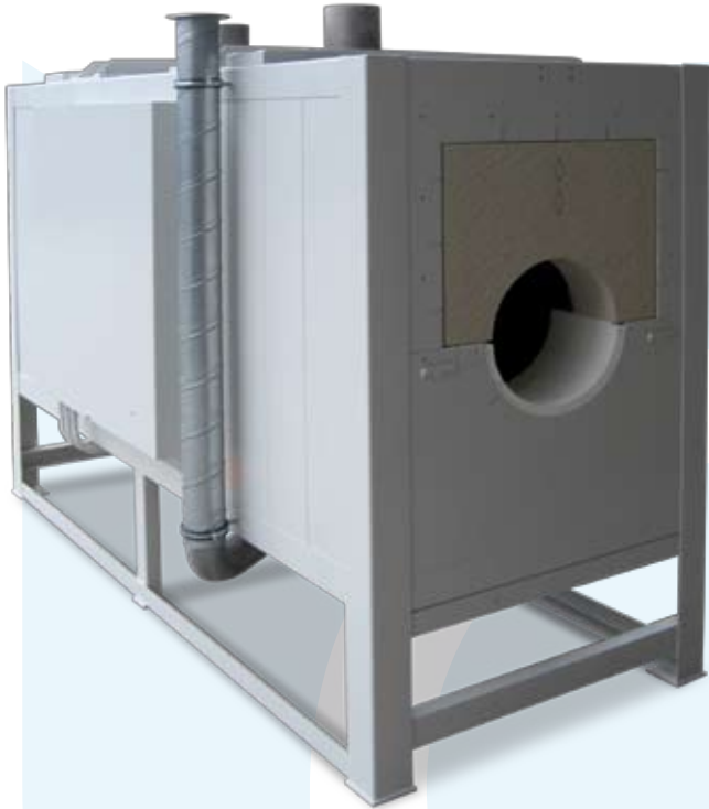
Elektrisch beheizter Rohrofen BT 900 in kundenspezifischer Ausführung zum Wärmebehandeln von Edelmetallen. Anschlüsse für forcierte Kühlung/Belüftung der Brennkammer. Anschlussleistung 40 kW/58A, Tmax 1050°C
