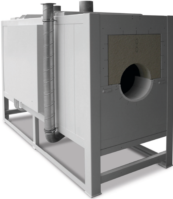
Elektrisch beheizter Rohofen BT 900 in kundenspezifischer Ausführung zum Wärmebehandeln von Edelgasen. Anschlüsse für forcierte Kühlung/ Belüftung der Brennkammer. Anschlussleistung 40 kW/58A, Tmax 1050°C
