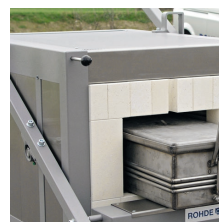
Härtkasten mit Schutzgasanschluss und Gasvorwärmung (optional)
