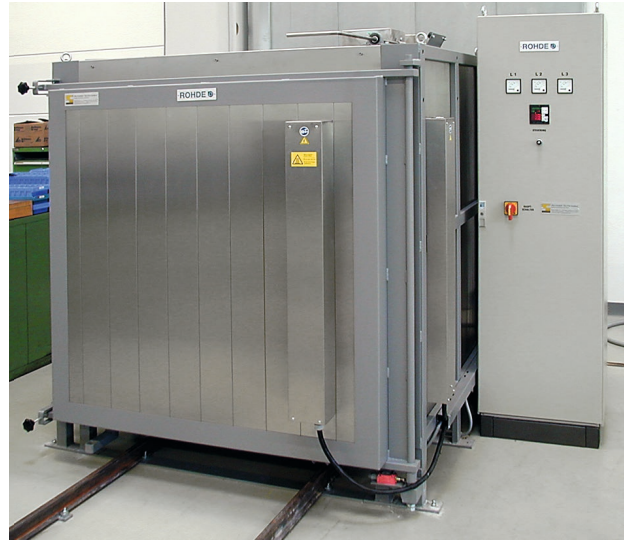
Herdwagenofen HWE 1000 mit hydraulischer Hubtür und automatischem Herdwagen
