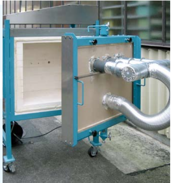
Gasbefuerter Kammerofen KG 450 A in Sonderausführung, zum Test von Feuerschutzmanschetten. Besonderheit: schnelle Aufheizrate zur Brandsimulation und Datenarchivierung. Anschlussleistung 60kW, Tmax 1200°C.
