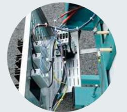
Kompakte, ausklappbare Elektrik in der Ofenrückwand
