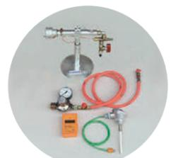
Raku-Komplettsatz (Rakubrenner, Druckregler, Manometer, Temperaturmessgerät, Thermoelement)
