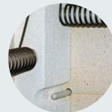
Thermoelement, geschützt eingebaut
