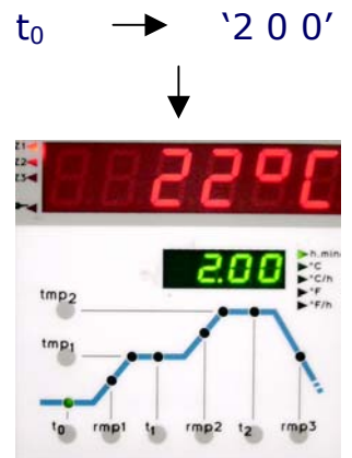
Fig. 8: Situatie na invoeren van 2 uur startvertraging
