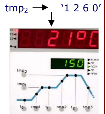
Fig. 11: Situatie na invoeren van rmp_1 , 150 °C/h
