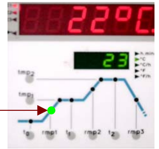
Fig. 5: Weergave van setpointtemperatuur en lampje bij lopend interval.
