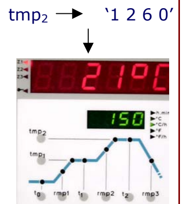
Fig. 13: Situatie na invoeren van t_1 , 10 min.
