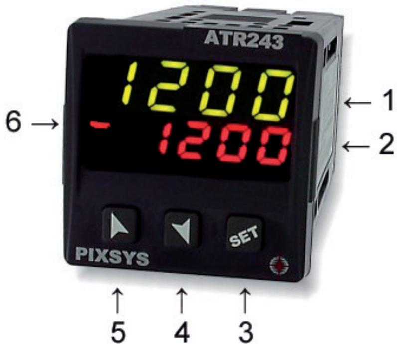
Mit dem Programmregler lässt sich eine langsame Aufheiz-Phase (Menü – GrAd -) bis zu einer frei wählbaren Trocknungstemperatur (Menü - Set 1 -) vorgeben. Nach Erreichen dieser Trocknungstemperatur fährt der Regler mit maximaler Aufheizgeschwindigkeit die Endtemperatur (Menü - Set 2 -) an. Die Brenntemperatur wird über die Brenndauer (Menü - A.t I. -) gehalten. Danach schaltet der Regler auf - StoP - . Die Ist-Temperatur im Ofen wird weiter angezeigt.
